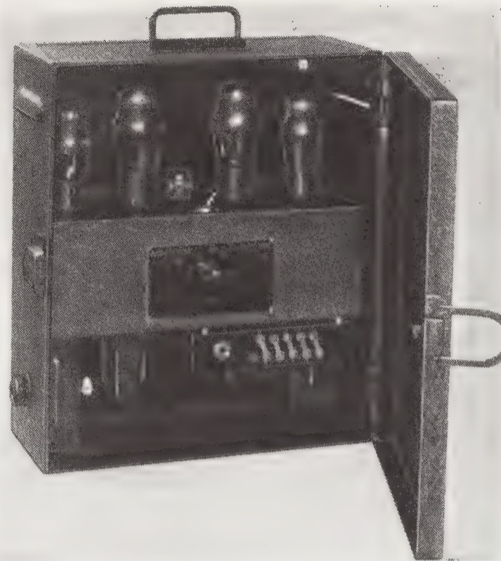
Amplificador Acousticon de cuatro tubos para las personas tardas de oído. Usa tubos normales para radio y se halla permanentemente instalado en una pared de la caseta de proyección. Sus dimensiones son tan sólo de 13½ x 11¼ x 6 pulgadas, de modo que no estorba la instalación del equipo restante.
